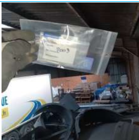
Matériaux : ZPSO-003 Prélèvement : P003 Description : Plaques en fibres-ciment (y compris plaques « sous tuiles ») Localisation : Rez de chaussée - HANGAR Résultat : Présence d'amiante
